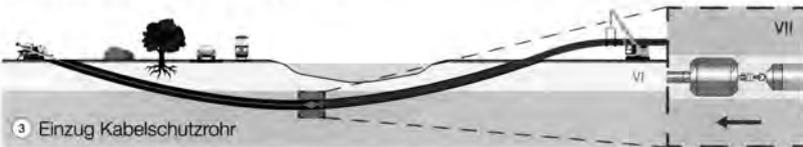
Zuletzt wird das zu verlegende Erdkabel in das Kabelschutzrohr eingezogen. Auf Grund der zulässigen Zugkräfte, die auf das Kabel einwirken, kann der Einzug des Kabels in der benötigten Länge erfolgen.
